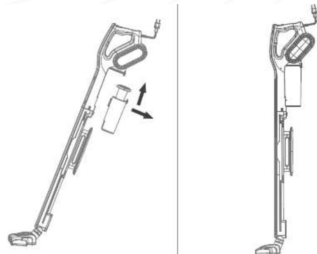
**Примечание:** устройство можно использовать без удлиняющей трубки, для этого установите необходимую щетку или насадку в соответствующий паз на корпусе.
