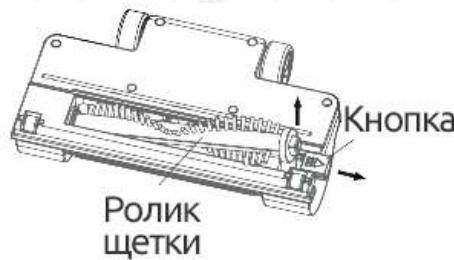
2. В случае намотки волос на ролик пневматической щетки<sup>\*</sup>, снимите щетку, нажмите на специальную кнопку и извлеките ролик для очистки.
