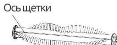
3. Удалите волосы вдоль оси ролика, промойте его чистой водой и высушите естественным образом, после чего установите обратно.
